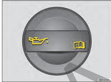
Fig. 197 En el compartimento del motor: tapón de la boca de llenado del aceite del motor.
