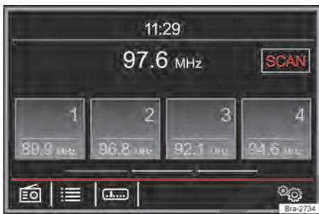
**Fig. 118** Operación de la radio: búsqueda automática activada (SCAN).
