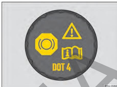
Fig. 200 En el compartimento del motor: tapón de cierre del depósito del líquido de frenos.
