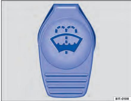
Fig. 195 En el compartimento del motor: tapa del tanque de agua de los lavaparabrisas.
