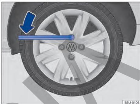
Fig. 211 Cambio de rueda: aflojar los tornillos de la rueda.
