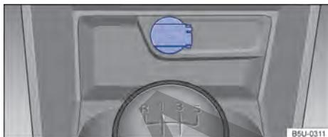
Fig. 99 En la consola central delantera: toma de corriente de 12 V.
