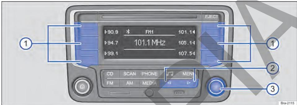
**Fig. 156** Cambio de emisora por medio de las teclas de función o de las teclas del equipo.
