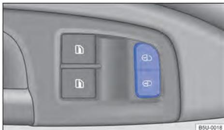
Fig. 45 En la puerta del conductor: tecla del cierre centralizado.
