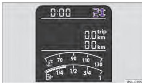
Fig. 76 En el panel de instrumentos : indicador de cambio de marcha (variante 1).
