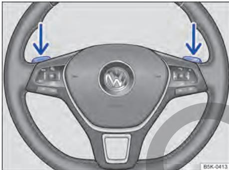
Fig. 84 Volante con selectores basculantes de Tiptronic.
