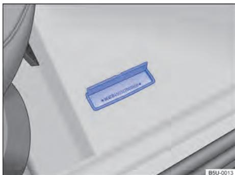
**Fig. 218** Delante del asiento del acompañante delantero: número de identificación del vehículo (número del chasis) en el piso, delante del asiento del acompañante delantero.
