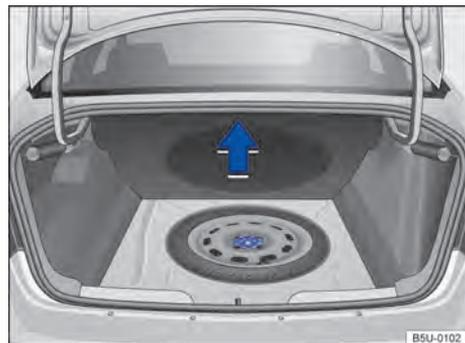
**Fig. 171** En el maletero, por debajo del revestimiento del piso: rueda de emergencia y herramientas de a bordo.
