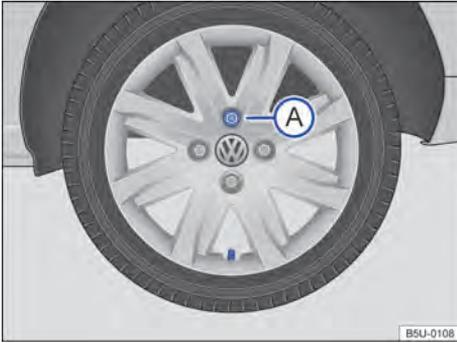
**Fig. 213** Cambio de rueda: secuencia de desmontaje de los tornillos de la rueda.
